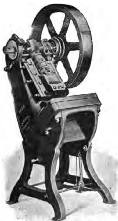
Presse Bliss pour découper et estamper les fonds de boîtes.
